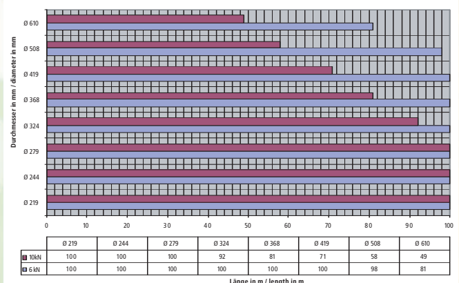
Vortriebslängen PBA 95 / jacking lengths PBA 95
